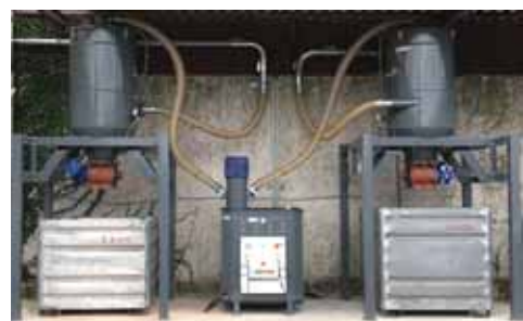
Beispiel: Filter-Vorabscheider mit Zellenradschleuse
