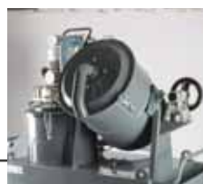
Spänebehälter einfache Entleerung durch Kurbel-Kippsystem
