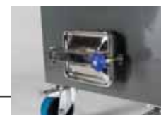
Revisionsöffnung für die schnelle Reinigung
