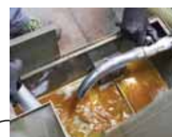
schnelle Entleerung der gereinigten Flüssigkeit
