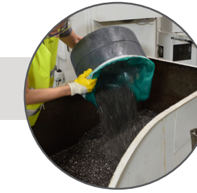
Pratique déchargement des copeaux avec le panier grillage ou le bac collecteur extractible
