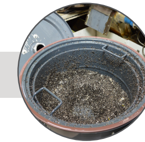
Panier grillage pour la séparation des copeaux des huiles aspirés
