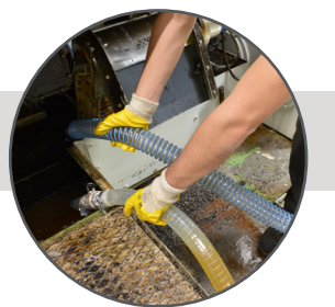
Pompe immergée pour le déchargement simultanée à l'aspiration Modèles "MPI"
